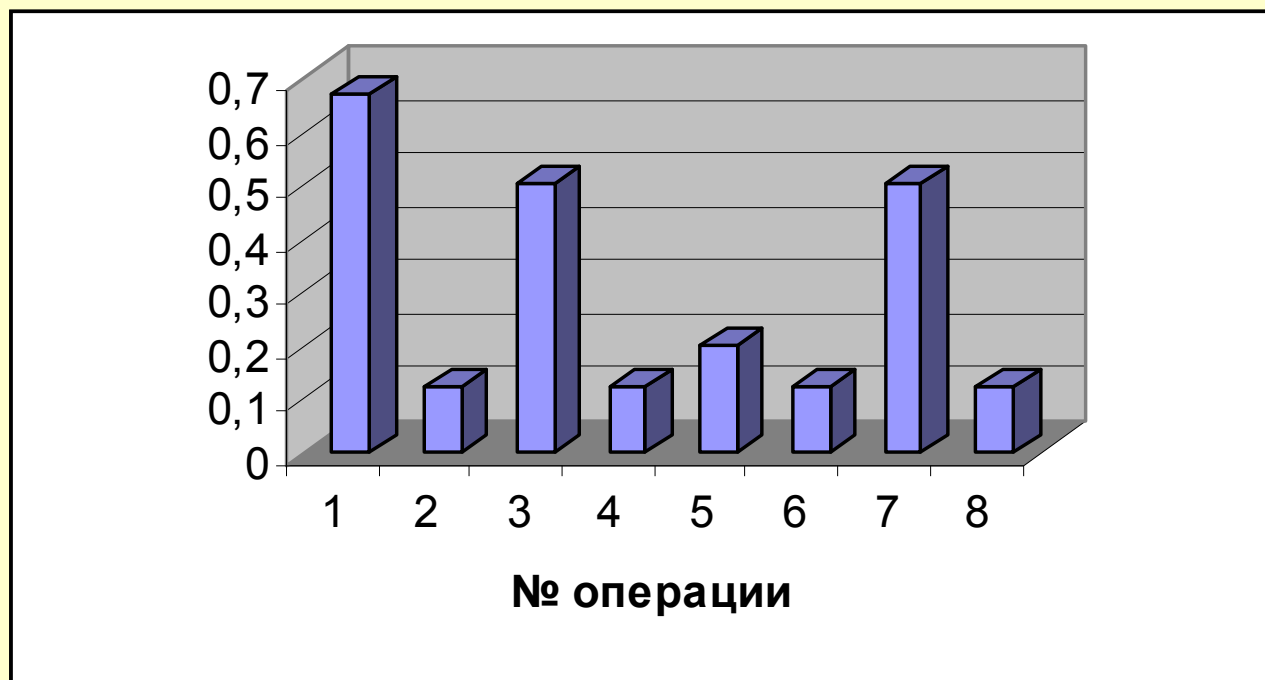
Рис. 2. Диаграмма распределения неопределенности пробоподготовки по операциям
