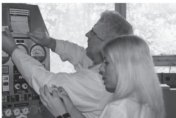
Сотрудники лаборатории таблетированных лекарственных средств науч. сотр. Гончаров Н.А. и инженер Лаптева Л.Н. устанавливают технологические режимы грануляции в псевдооживленном слое
