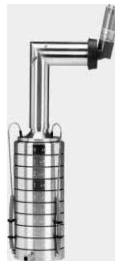
Корреляция распределения частиц по размерам на многоступенчатом импакторе и их осаждения в дыхательных путях человека (рисунок предоставлен фирмой «Erweka»)
